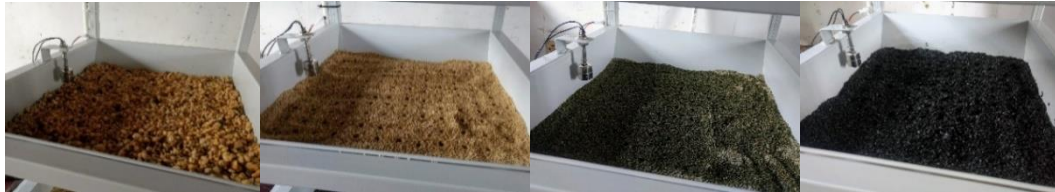
Figura 18. Material filtrante del dispositivo diseñado, de izquierda a derecha: Grava (8 cm de espesor), arena (8 cm de espesor), zeolita (5 cm de espesor) y carbón activado (7 cm de espesor).
