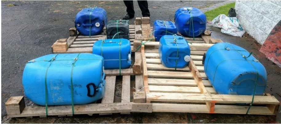
Figura 20. Sistema de flotación del dispositivo (Elaboración propia).
