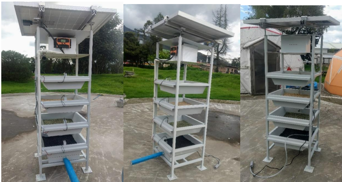
Figura 23. Dispositivo construido para la remoción de sólidos, adsorción de amonio y aireación del agua.
