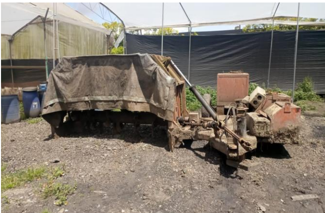
Compostadora engragada de hacer el volteo de pilas y dromel para tamizar el abono.
