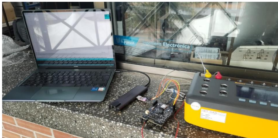
Figura 60. ProSim 8 Vital Signs Patient Simulator de FLUKE con la tarjeta.
