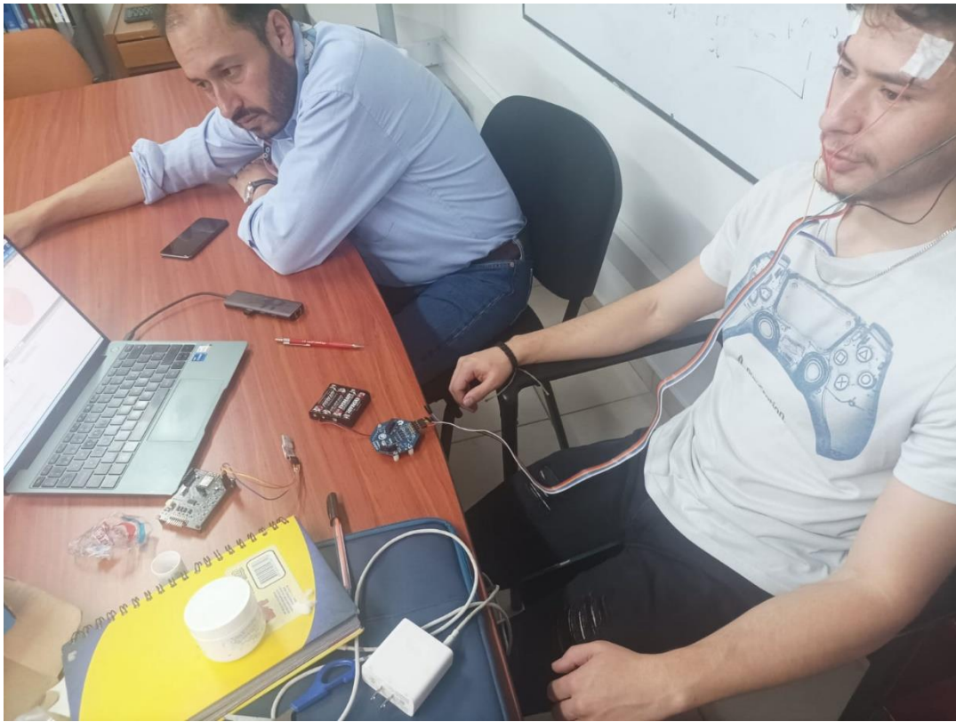
Figura 79. Conexiones persona a tarjeta para adquisición EEG.
