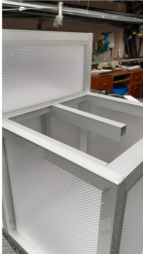
Figura 17. Se evidencia tubo de aluminio cuadrado temporal para sistema de deformación. Se identifica la tabla del piso de sección 1.
