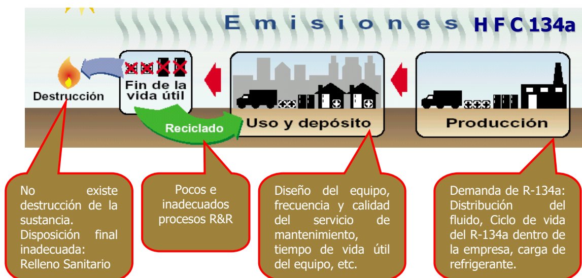
Figura 4.8: Emisiones directas generadas por la manufactura de equipos de refrigeración con R-134a en Colombia
