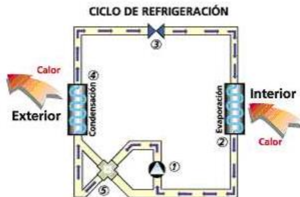
Figura 3.10: Ciclo de refrigeración
