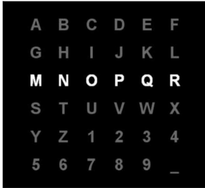
Figura 13. Ejemplo de una matriz 6x6 utilizada como fuente de los estímulos visuales para un *Speller* basado en P300. Imagen extraída de [39].
