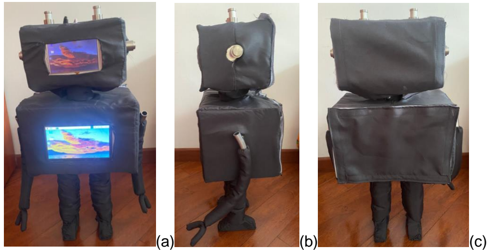
Figura 6-20. Cobertura en tela antifluido(a) Vista Frontal (b)Vista lateral (c)Vista trasera
