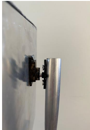
Figura 6-19. Unión Motor MG90S con brazo en aluminio
