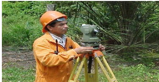
Fotografía N° 1. Levantamiento topográfico de las líneas.
