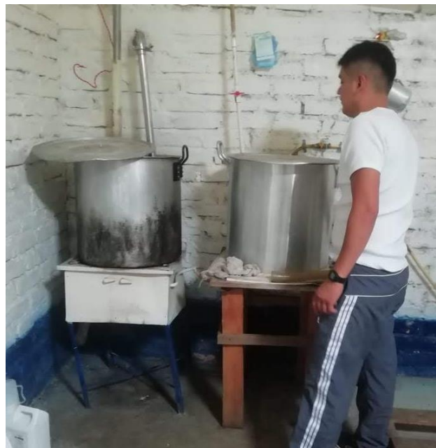
Figura 5. Ollas que funcionan a gas para calentar el agua con el fin de pringar los equipos que son utilizados para el proceso de extracción de leche y conservación.
