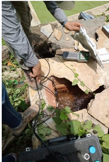
Figura 13. Medición en campo con el multiparámetro. Realizado por: Autora
