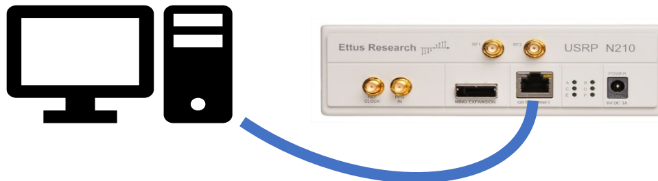
Figura 46 Conexión PC a USRP
