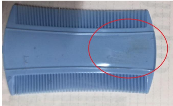
Imagen 10. No conformidad por lluviosas
