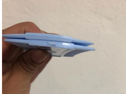
Imagen 6. No conformidad por picacho
