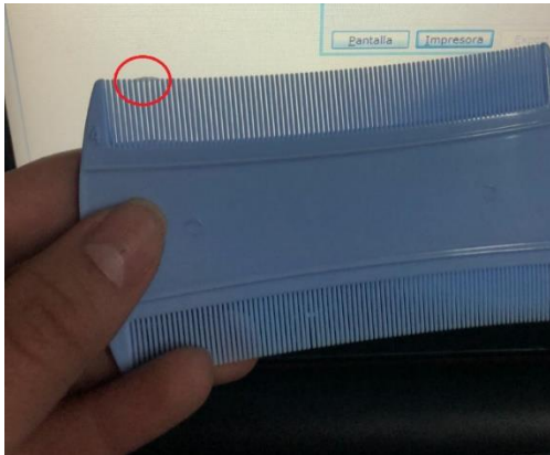
Imagen 5. No conformidad por rebaba
