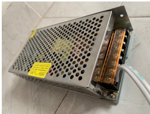
Figura 37. Fuente conmutada de 12 V
