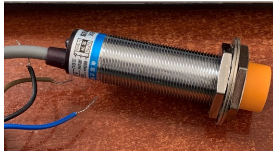
Figura 28. Sensor de proximidad sólidos.
