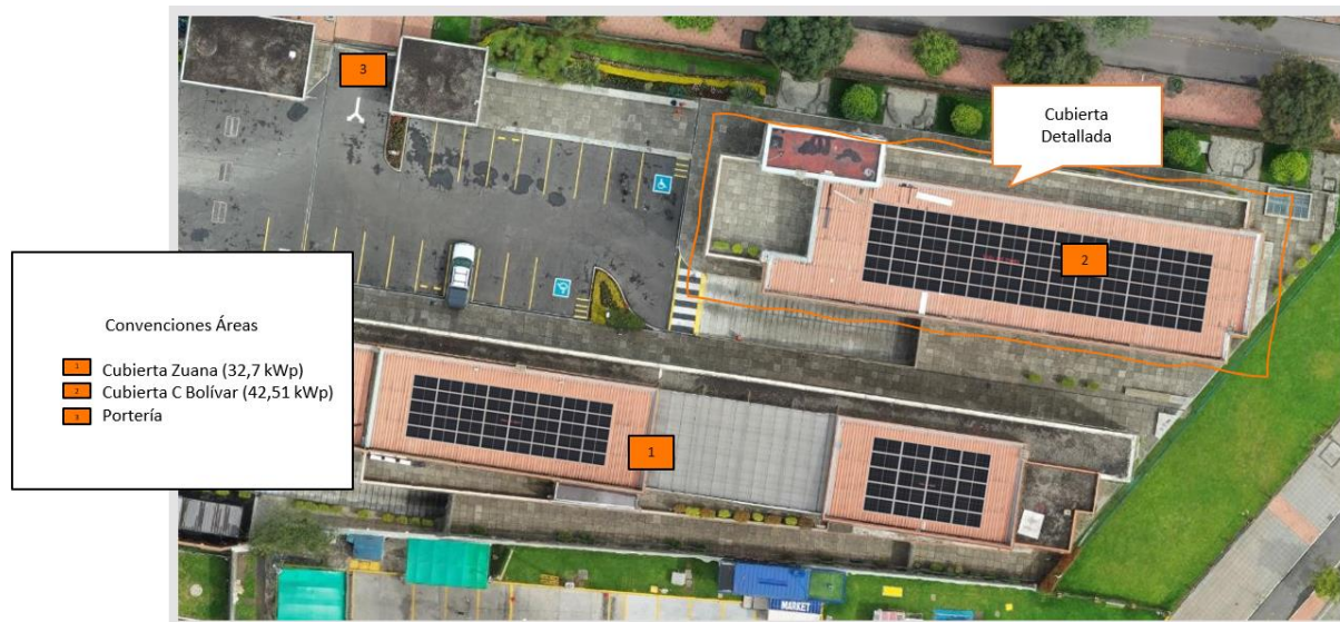
Figure 54 Propuesta de ubicación de paneles solares
