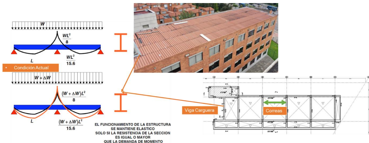
Figure 49 Análisis estructural Torre A
