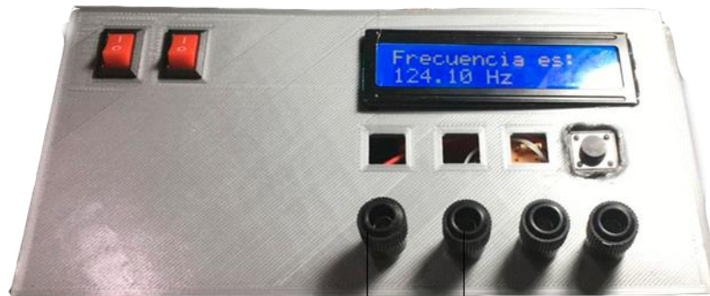
Conexión A entrada roja de bobina Conexión B entrada negra de bobina
