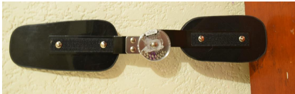
Figura 55 soporte derecho del exoesqueleto parte externa
