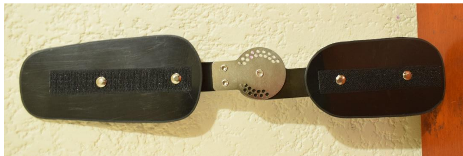
Figura 56 soporte derecho del exoesqueleto parte interna
