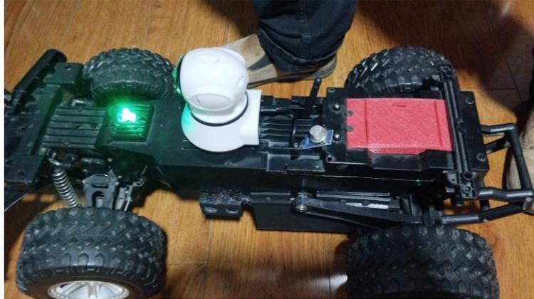
*Figura 47. Prueba sensor de proximidad derecho con su led*
