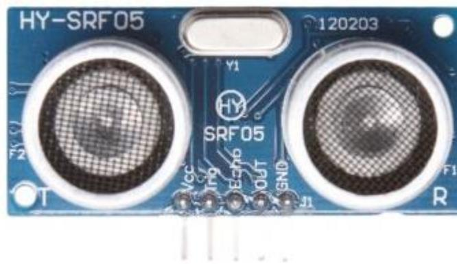
Figura 19. Sensor de distancia ultrasonido seleccionado para el robot [13]
