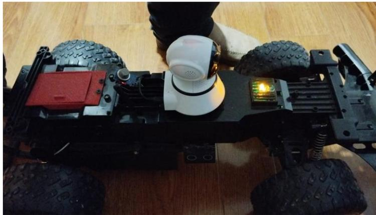
*Figura 48. Prueba sensor de proximidad izquierdo con su led*
