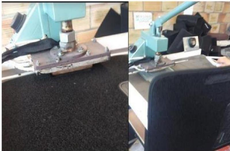
Figura 37. Perforación de alfombra en Calor
