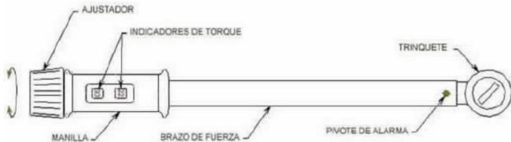
Figura #1. Descripción grafica de las partes de un torquímetro.
