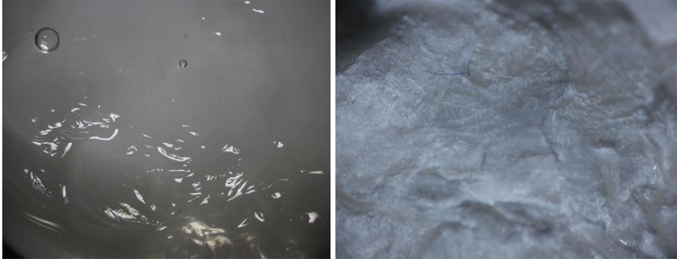
**Figura 73.** Imágenes de estereoscopia del hidrogel DAA compuesto por Polivinil Alcohol (PVA) y Alginato de Sodio (AS) en una relación de 7 y 3 mL respectivamente en su estado normal y después del proceso de liofilizado.
