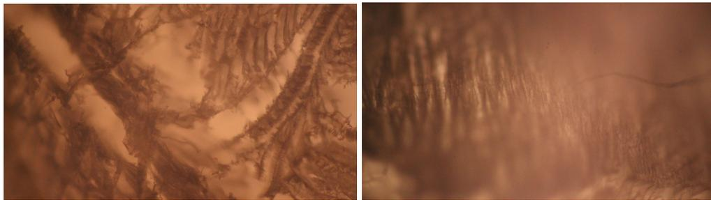
**Figura 72.** Micrografías ópticas del hidrogel DAG compuesto por Polivinil Alcohol (PVA) y Alginato de Sodio (AS) en una relación de 3 y 7 mL respectivamente.
