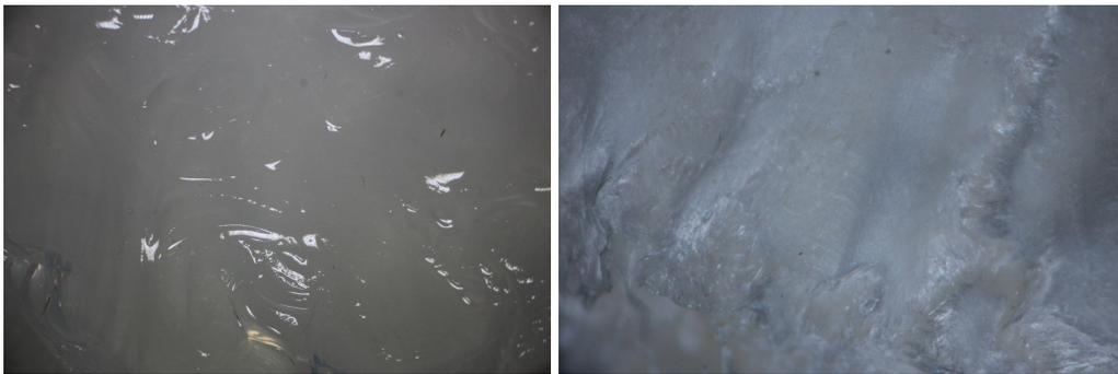
**Figura 80.** Imágenes de estereoscopia del hidrogel DAF compuesto por Polivinil Alcohol (PVA) y Alginato de Sodio (AS) en una relación de 5:5 mL en su estado normal y después del proceso de liofilizado.
