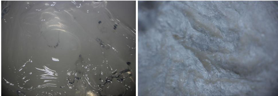
**Figura 67.** Imágenes de estereoscopia del hidrogel DAG compuesto por Polivinil Alcohol (PVA) y Alginato de Sodio (AS) en una relación de 7 y 3 mL respectivamente en su estado normal y después del proceso de liofilizado.
