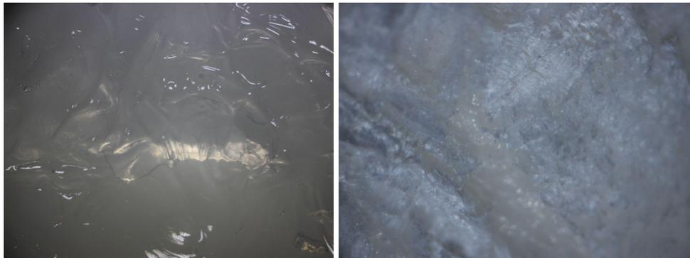
**Figura 68.** Imágenes de estereoscopia del hidrogel DAG compuesto por Polivinil Alcohol (PVA) y Alginato de Sodio (AS) en una relación de 5:5 mL en su estado normal y después del proceso de liofilizado.
