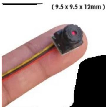
Ilustración 66. Módulo de cámara, sensor CMOS. Fuente: (Connecting Buyers with Chinese Suppliers, s.f.)
