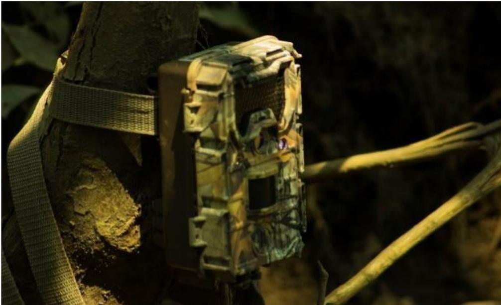
Las cámaras se instalaron a una altura variable del suelo, dependiendo de los rastros que se encontraban en la zona, y se ceban a dos metros aproximados de la cámara (rango óptimo de captura de la cámara). Esto para lograr una captación panorámica del organismo que se logre registrar (Figura 10).
