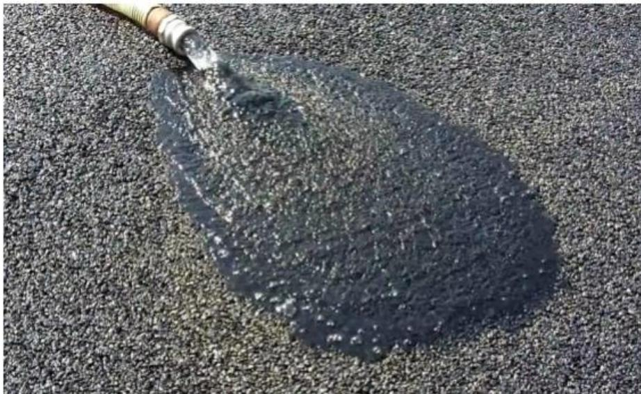
*Figura 8 Pavimento Permeable de tipo mezcla asfáltica porosa (Universidad de los Andes, 2017)*
