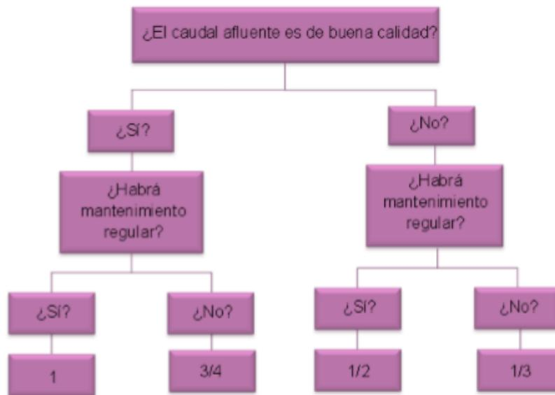
Figura 20 Coeficiente de seguridad (Dirección de Investigaciones Científicas y Tecnológicas -DICTUC-, 1996)
