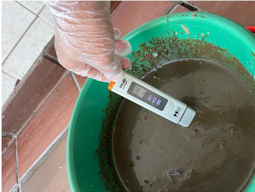
Anexo 21. Medición de pH de lodos de reactores fallidos. Fuente: (Autores, 2023).
