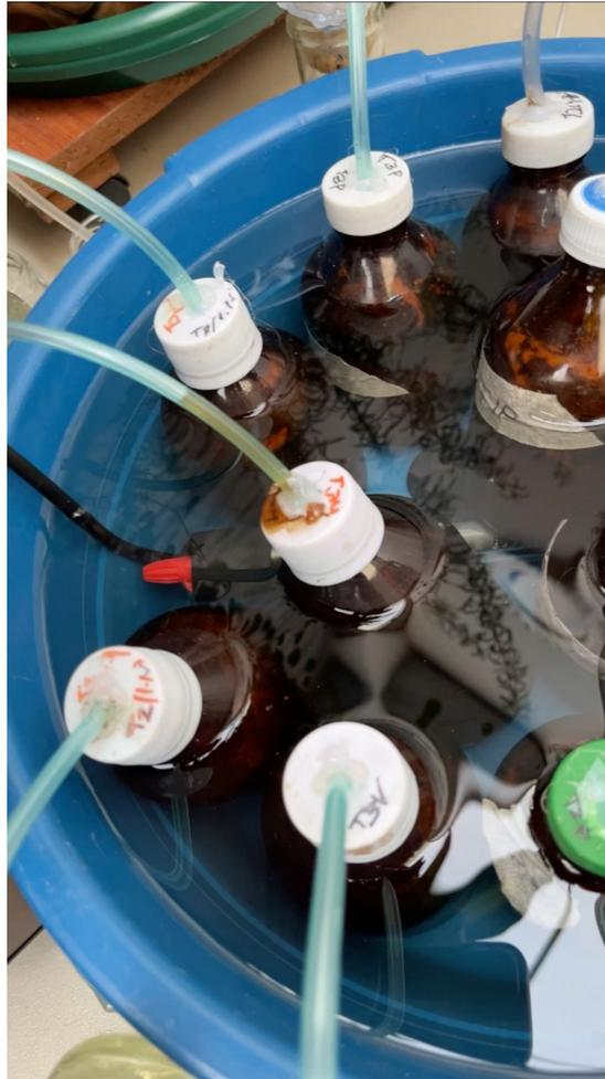
**Anexo 47.** Montaje con resistencia (30°C).
