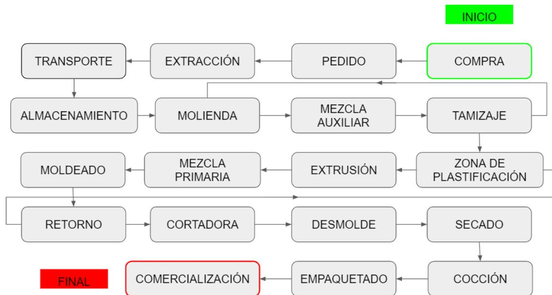
**Figura 17. Esquema funcionamiento Ladrillera Helios (Autor; 2019)**
