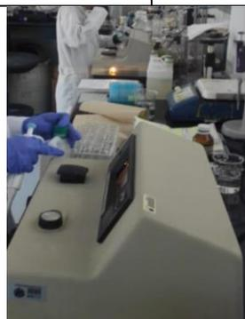
Figura 13 Prueba de coagulación del agua del río Bogotá por técnica espectrofotométrica
