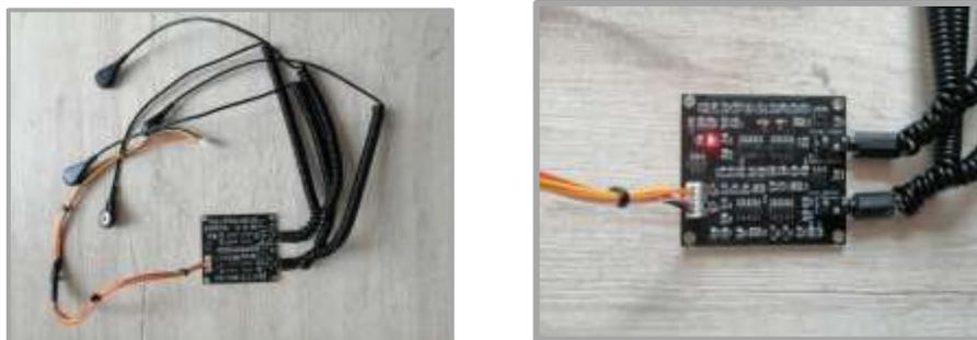
Figura 117. Implementaciones de la integración No.1 Paso de instalación de los electrodos. Pas del 4 al 5 con el estado de la Placa ON.
