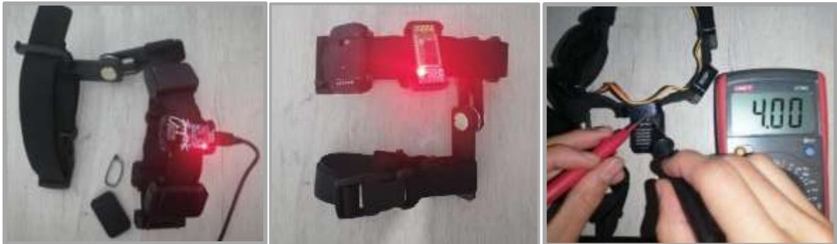
Figura 134. Pruebas de las mediciones de requerimientos. Indicadores leds y voltaje de la batería.
