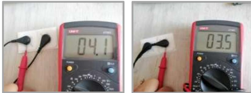
Figura 128. Impedancias de los electrodos.
