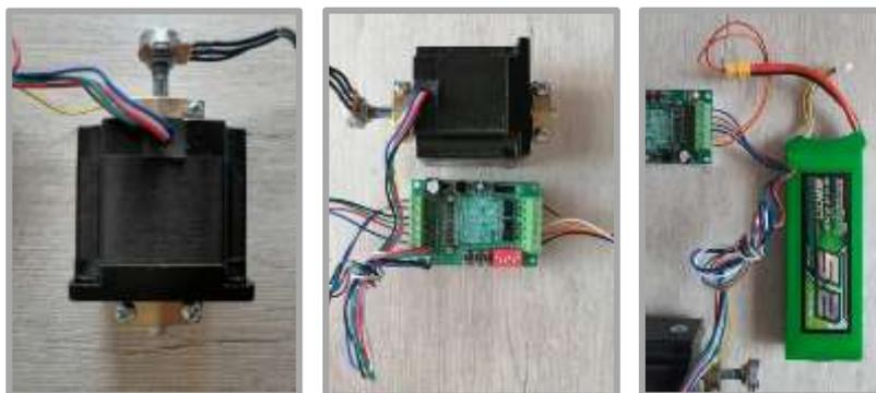
Figura 115. Implementaciones del subsistema D. Conexión del driver para el Motor, el motor y la batería de 11.1V a 5A.
