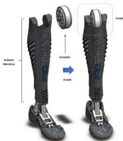
Figura 14. Posible diseño del prototipo de acople de rodilla bioelectrónica para prótesis transfemoral. Realizado en Solid Works.
