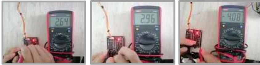
Figura 132. Pruebas de las mediciones de voltaje en la placa del subsistema A1.
