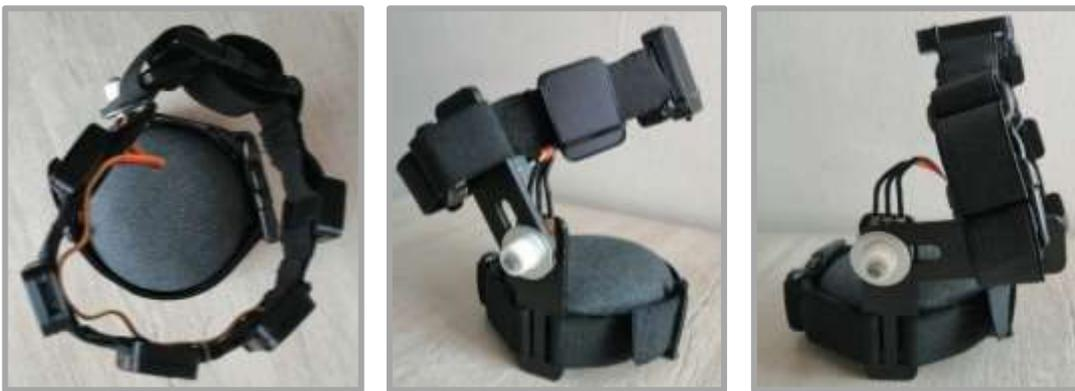
Figura 118. Implementaciones de la integración No.2. Paso del 1 al 3 implementación y ajuste del potenciómetro en la Interface. Verificación de rotación de  $0^\circ$  a  $70^\circ$ .
