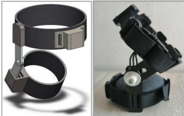
Figura 107. Implementación de la estructura "Interface de lectura de Variables físicas" construida en PLA con Bandas elásticas.
