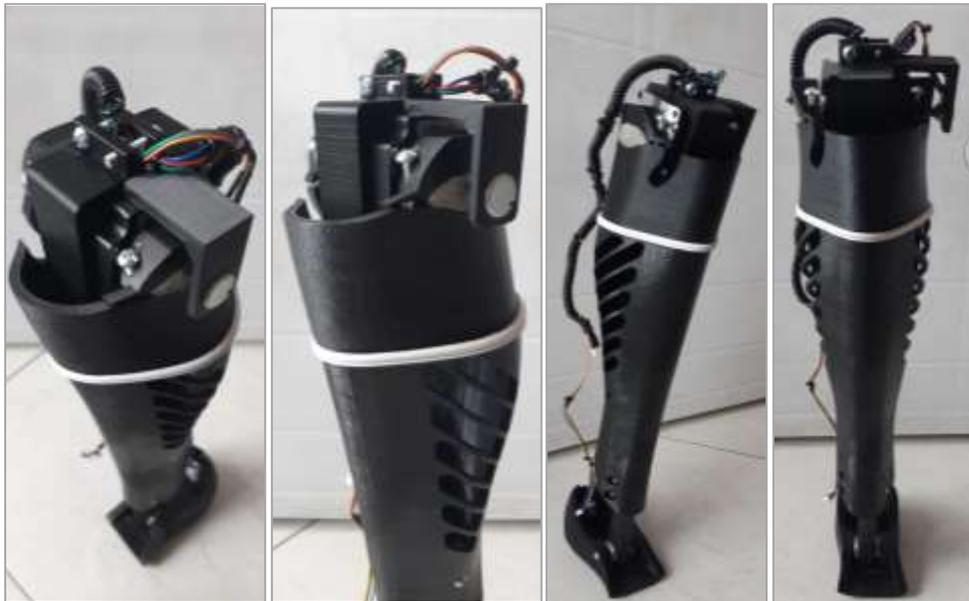
Figura 127. Montaje del actuador y Encoder sobre la prótesis mecánica.
