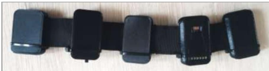
Figura 111. Implementación de la tarjeta de lectura y transmisión de variables físicas con implementación de módulos electrónicos. Vista con caja superior de protección.
