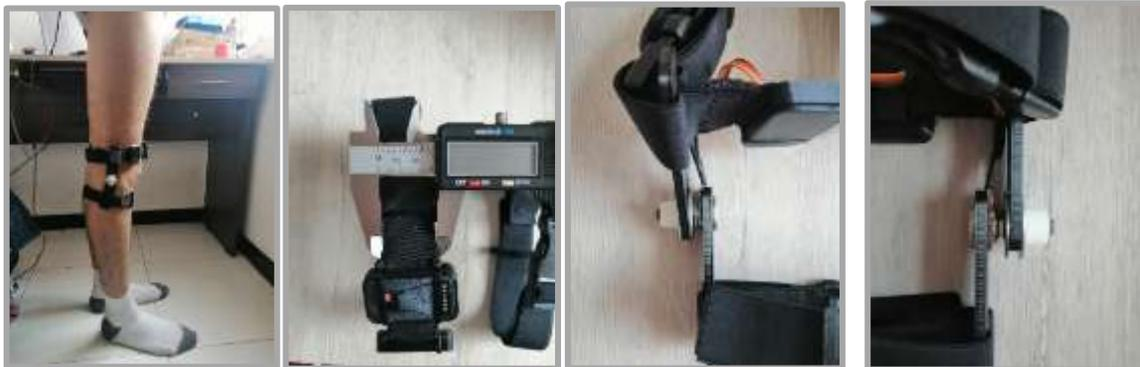
Figura 131. Pruebas de las mediciones de ancho y largo de las piezas, diámetro e instalación del potenciómetro en la interface, así como la instalación de las bandas sobre la pierna del voluntario.
