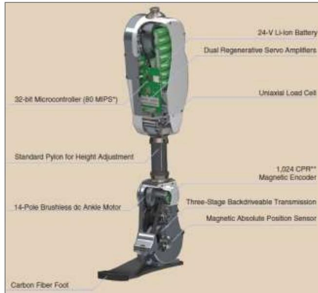
Figura 15. Representación del modelo de diseño asistido por computadora de los ciclos de mega instrucción de prótesis motorizada (MIPS) por segundo. (RCP) cuenta por revolución. [15]
