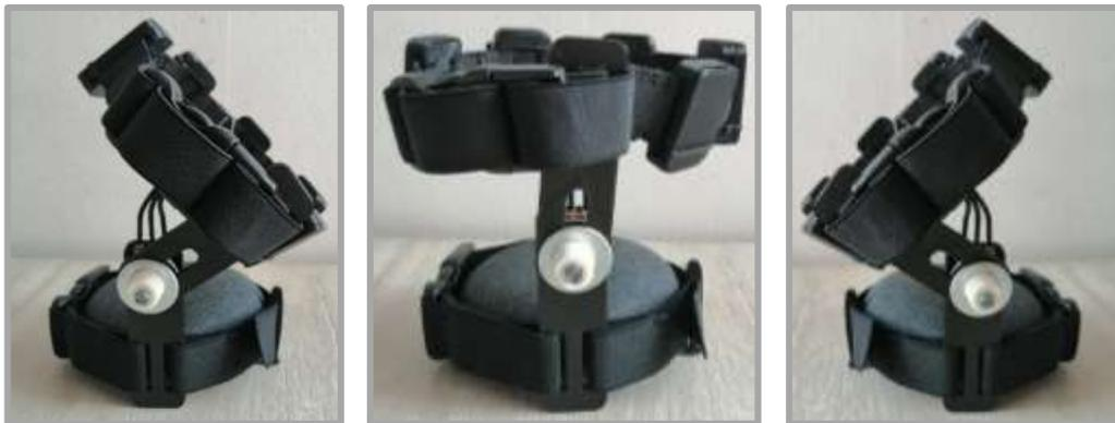
Figura 119. Implementaciones de la integración No.2. Paso del 3 al 6 implementación y ajuste del potenciómetro en la Interface. Verificación de rotación de  $0^\circ$  a  $70^\circ$ .
