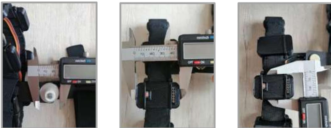
Figura 130. Pruebas de las mediciones de ancho y largo de las piezas de la interface No. 2. Parte 2
