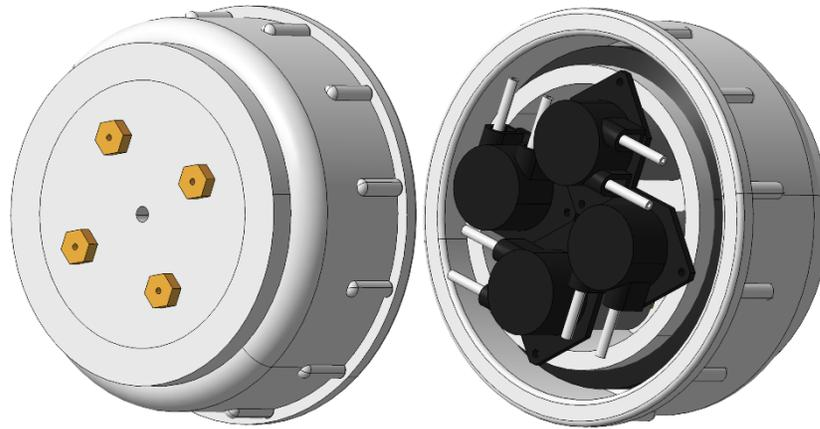
*Figura 52. CAD de diseño fundamental de Distribución de bombas peristálticas*
