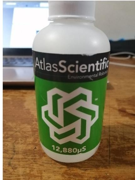
*Figura 117. Prueba del sensor de conductividad en sustancia de 12880  $\mu\text{S}/\text{cm}$ .*
