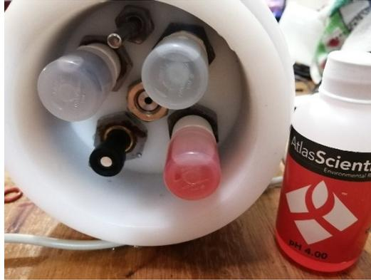
*Figura 111. Prueba del sensor de pH en sustancia de 4.00.*
