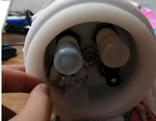
*Figura 122. Prueba de sensor de temperatura con cubo de hielo.*
