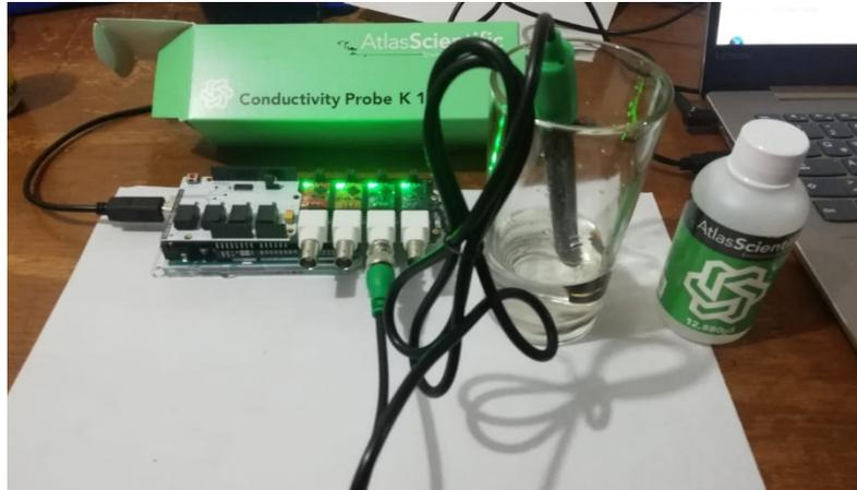
Figura 84. Calibración de sensor de Conductividad.
