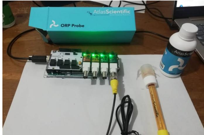
Figura 86. Calibración de sensor de ORP.
