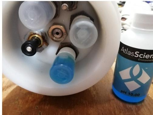
*Figura 112. Prueba del sensor de pH en sustancia de 10.00.*
