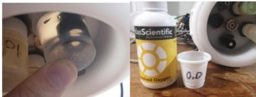
Figura 115. Prueba del sensor de O.D en sustancia de 0 mg/L
