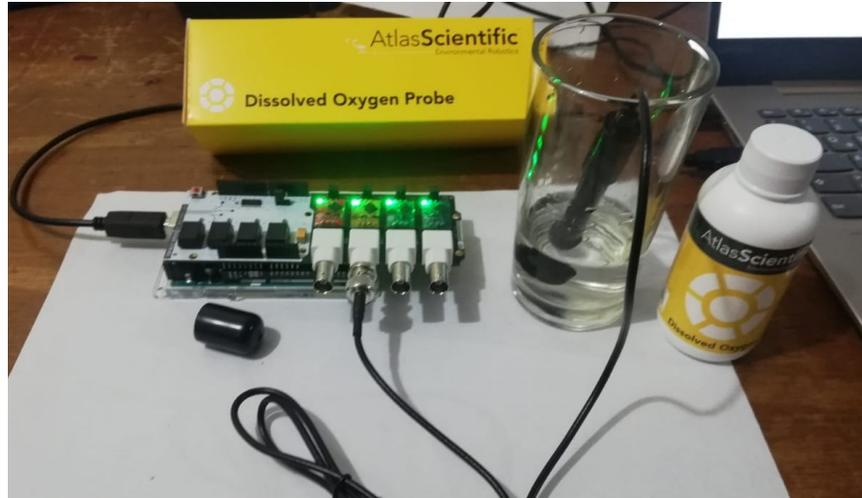
Figura 82. Calibración de sensor de O.D
