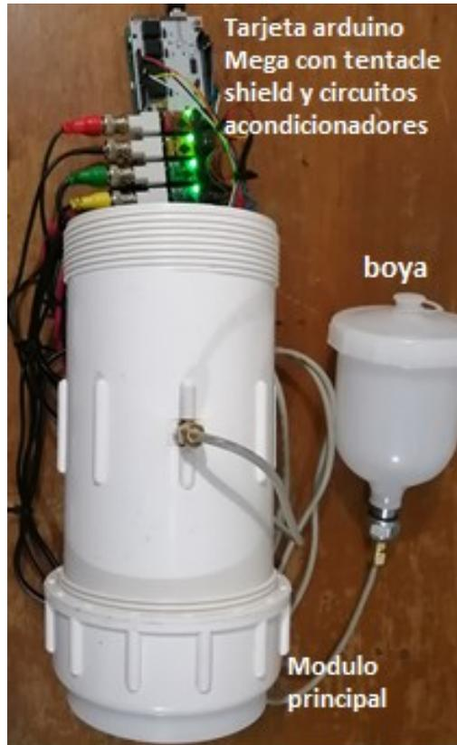
Figura 103. Partes fundamentales del módulo de medición.
