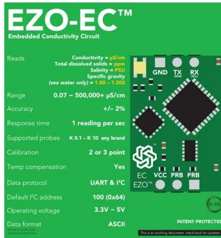
Figura 32. Hoja Técnica del circuito acondicionador de conductividad.
