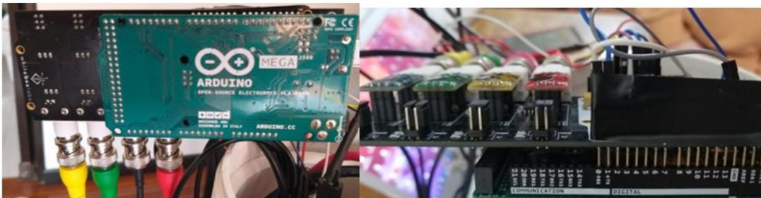
Figura 77. Conexión tentacle shield y arduino.
