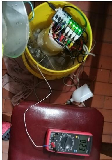
*Figura 121. Prueba de sensor de temperatura en agua caliente.*
