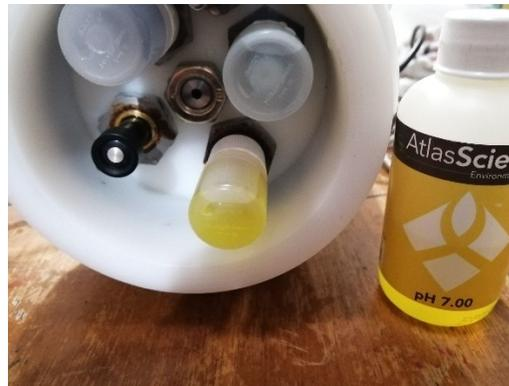
*Figura 113. Prueba del sensor de pH en sustancia de 7.00.*
