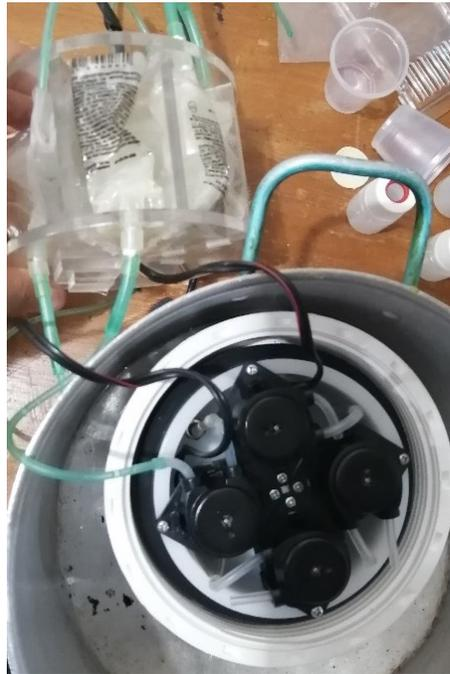
*Figura 109. Pruebas de funcionamiento de las bombas peristálticas.*
