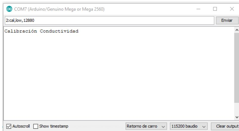
Figura 85. Calibración de sensor de Conductividad, punto low 12880
