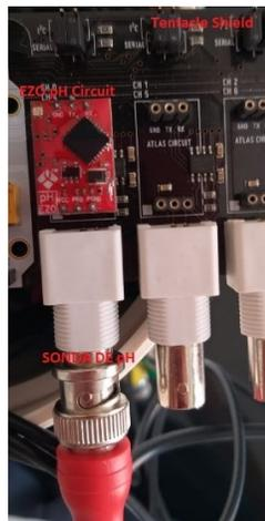
Figura 72. Circuito acondicionador de pH.
