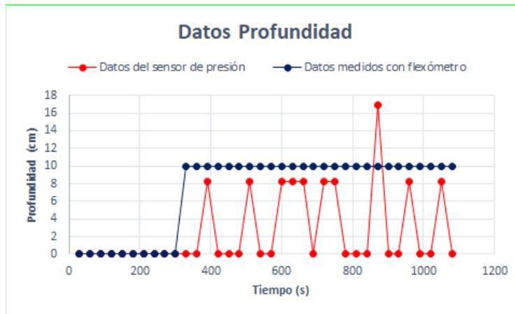
Figura 146. Gráfica de datos de profundidad con referencia de 5v.
