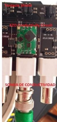
Figura 74. Circuito acondicionador de conductividad.
