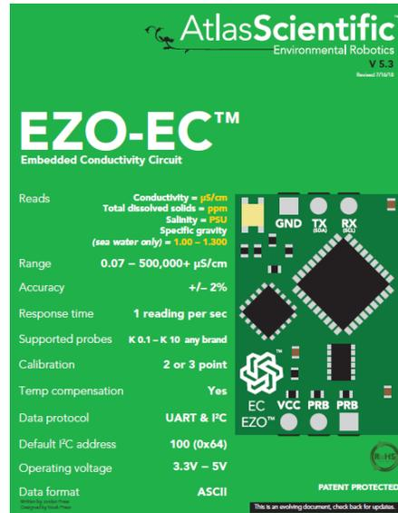
Figura 153. Información técnica del circuito EZO-EC
