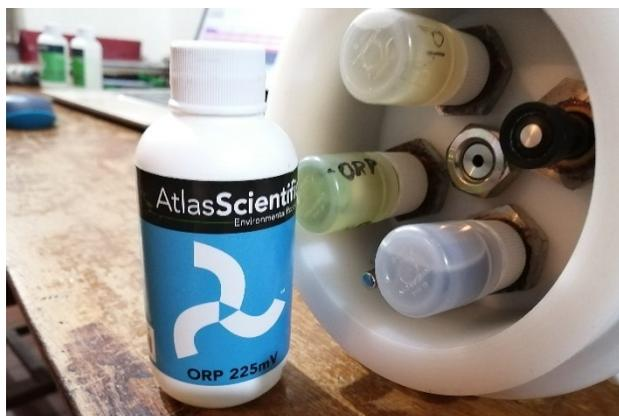
*Figura 119. Prueba del sensor de ORP en sustancia de 225 mV.*
