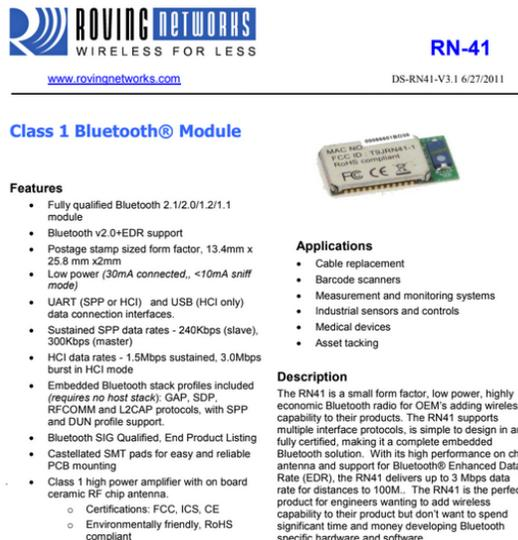
Figura 37. Hoja Técnica del módulo Bluetooth.
