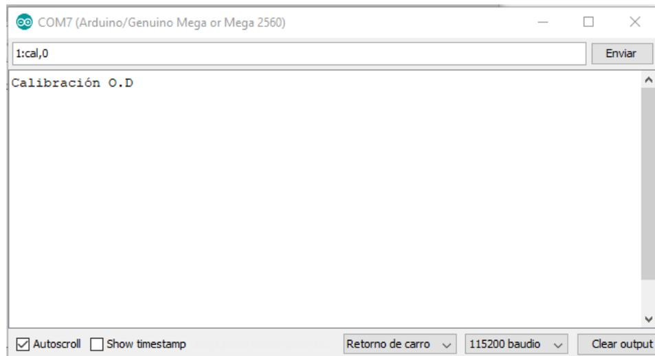
Figura 83. Calibración de sensor de O.D, punto 0
