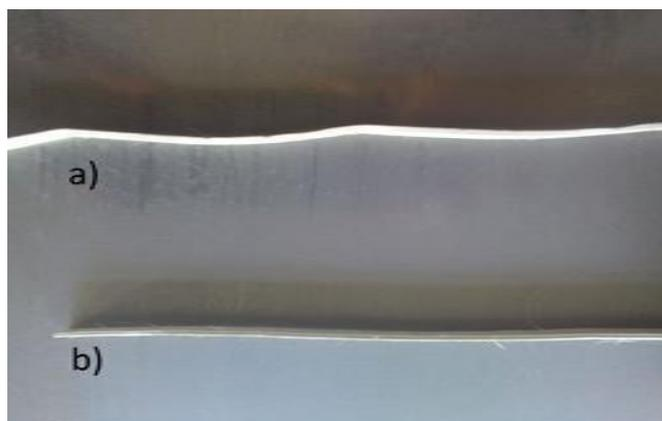
*Figura 28. a) Fibra extraída de tejido cruzado; b) Fibra extraída del tejido unidireccional (Autores)*
