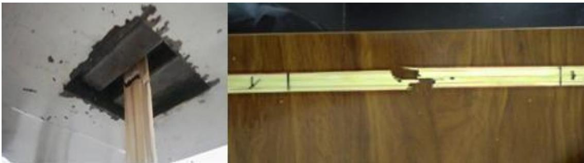
*Figura 31. Falla en la probeta por esfuerzo a tracción (Autores)*
