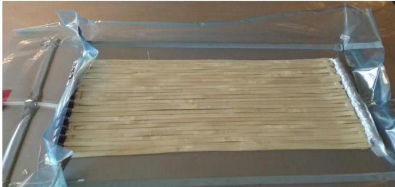
*Figura 15. Proceso RTM en tejido de fibras paralelas*
