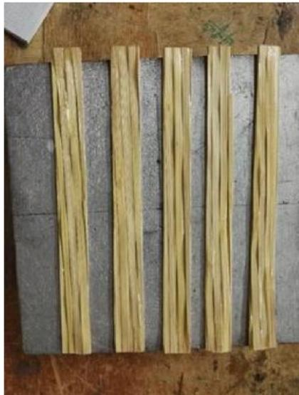
*Figura 30. Probetas cortadas con la norma ASTM D3039*
