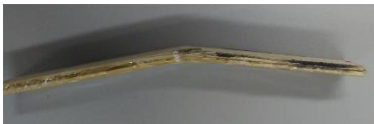
*Figura 32. Probeta luego de ensayo de flexión (Autores)*
