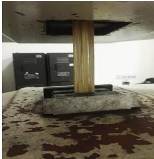
*Figura 18. Probeta sujeta en las mordazas de la Máquina Universal de Ensayos (Autores)*
