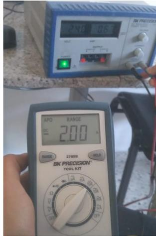
**Figura 5-8.:** Pico de corriente (A) motor 2
