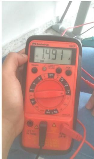
**Figura 5-9.:** Pico de corriente (A) motor del sistema de siembra
