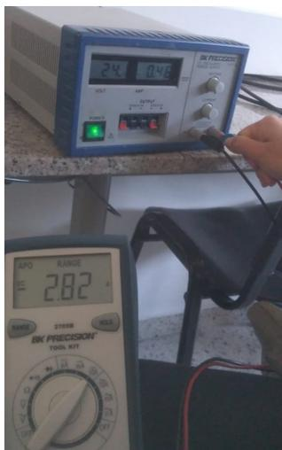
Figura 5-7.: Pico de corriente (A) motor 1
