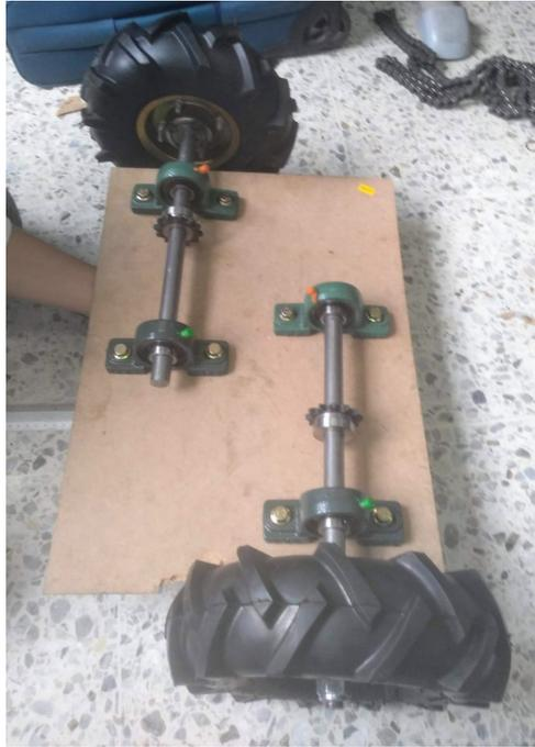
**Figura 6-15.:** Acople del motor a la rueda de control
