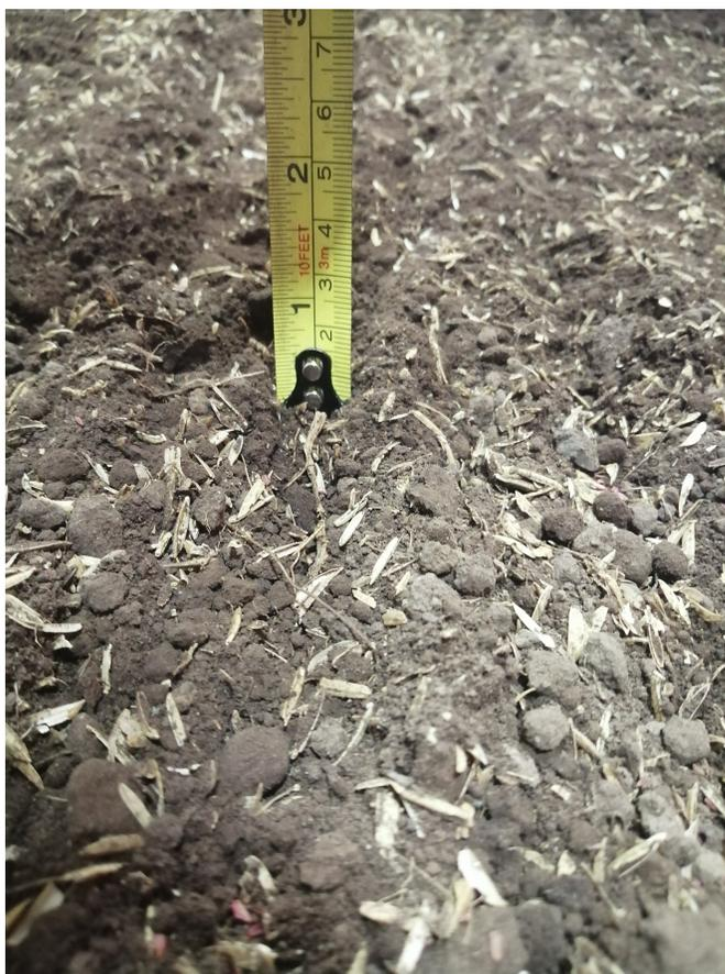
**Figura 6-36.:** Profundidad realizada por el cincel del prototipo
