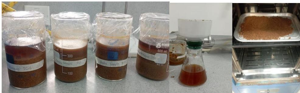
Para el procedimiento se usó 1 kg de cáscara de naranja y después del procedimiento el rendimiento del pulverizado fue de 0,472 kg, se tamizó el material con una malla de 300  $\mu\text{m}$  de diámetro de poro y se guardó en frascos de vidrio. (figura 18).
