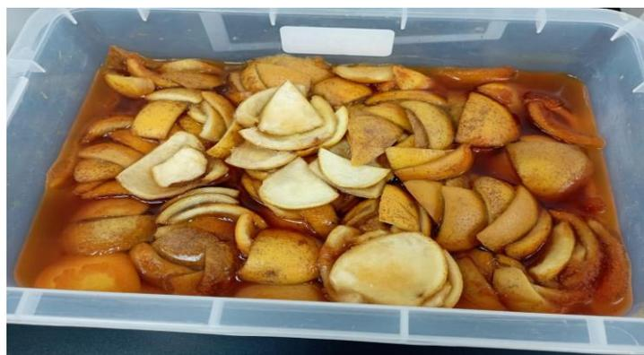
**Secado:** Se secaron las cáscaras a 105 °C durante 15 horas para eliminar aceites esenciales que pueden interferir en el proceso.
