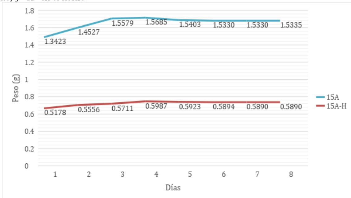
Figura 35. Degradabilidad del pitillo comestible en el tiempo
