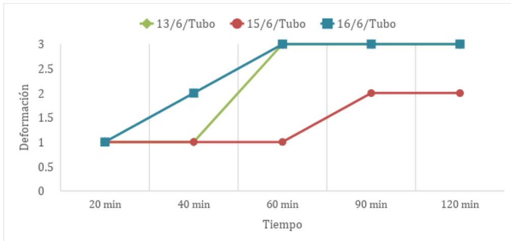
Figura 34. Deformación de pitillos piloto con almidón de maíz en agua con azúcar
