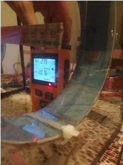
Medición de la intensidad del campo al lado de la bobina
