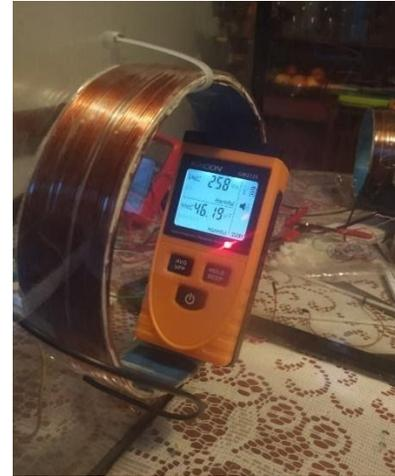
Medición de la intensidad del campo en el centro de la bobina
