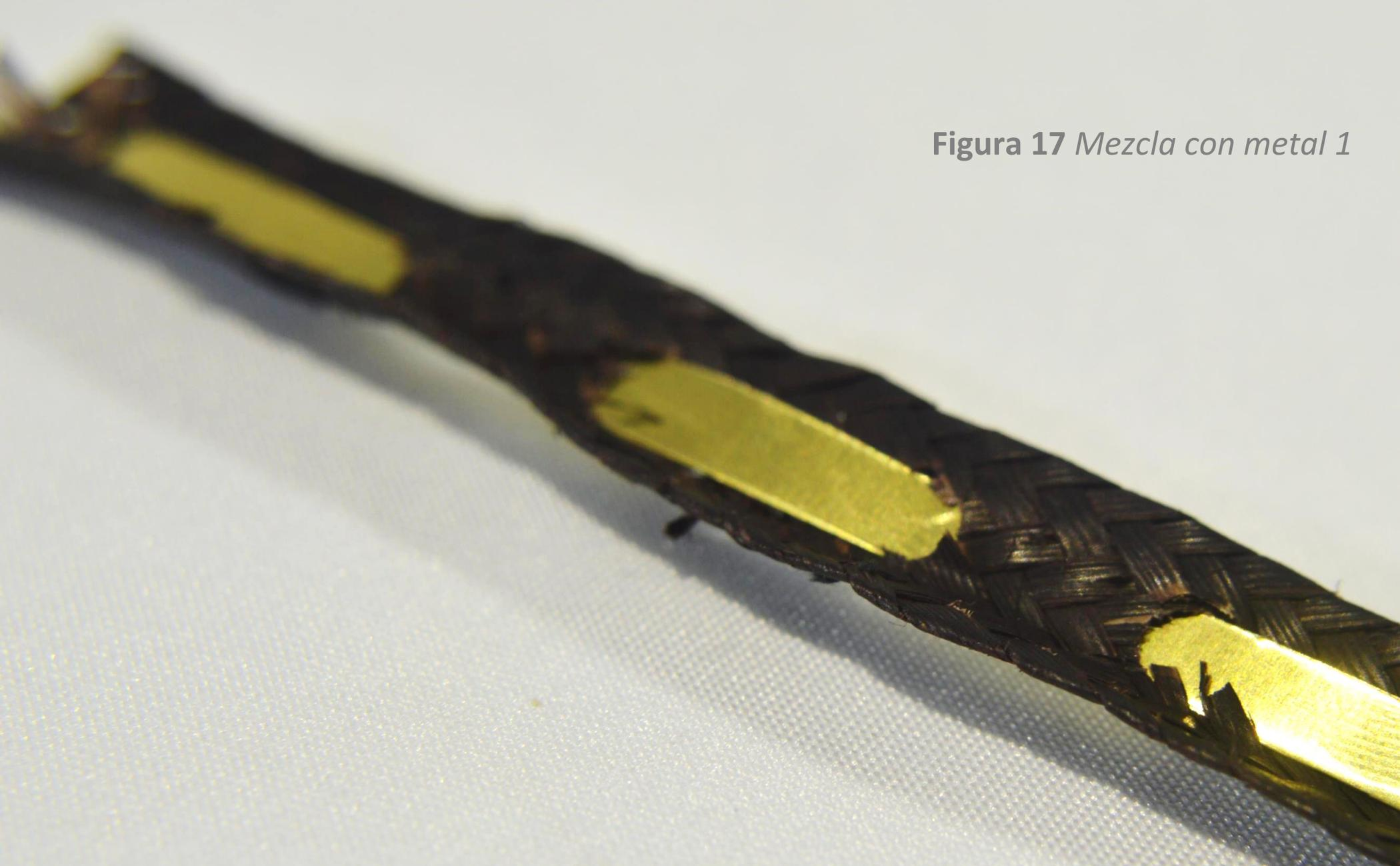
Perforamos la caña flecha haciendo orificios dejando una distancia entre ellos de 2 cm y se atraviesa con una lamina de laton
