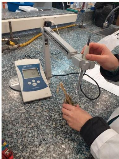
**Figura 31.** *Determinación del pH del retamo espinoso.* Autores (2019)
