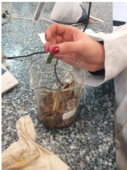
**Figura 29.** *Determinación del pH de la paja de maíz.* Autores (2019)
