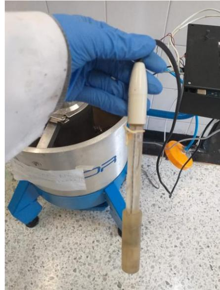
**Figura 14.** Sonda de pH. Autores (2019)
