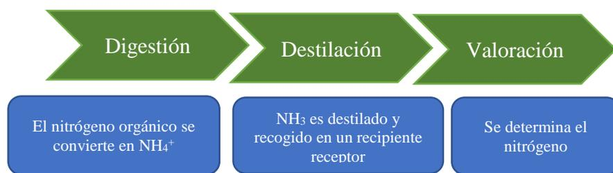
**Figura 10.** *Etapas del método Kjeldahl.* Adaptado de (ITWReagents, 2018)
