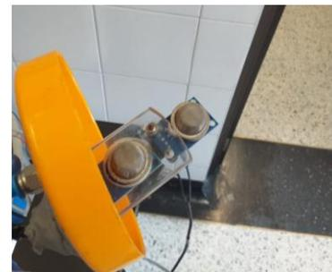
**Figura 17.** Sensores MQ-4 y MQ-2
