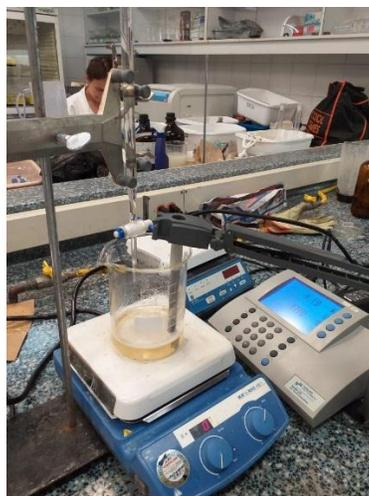
**Figura 27.** Determinación de los AGV. Autores (2019).
