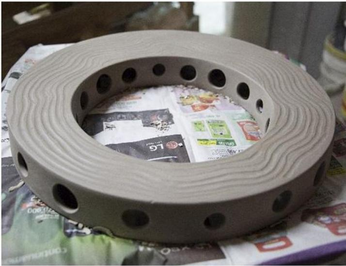
5. Al hacer el desmoldado se procede con el corte de los vacíos con una herramienta llamada troquel circular.
