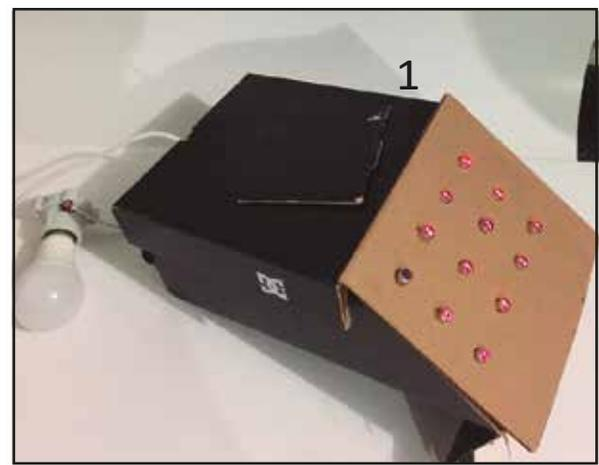
Figura 42. Prototipo láser. Prototipo 1 falla de punto láser de referencia reemplazo con bombillo.
