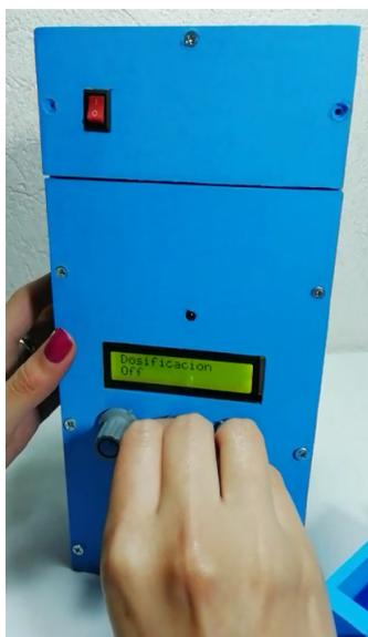
**Figura 6-77.:** Visualización segunda opción del menú mediante la pantalla LCD ubicada en la etapa instrumental del prototipo de laboratorio. Fuente: Autor.
