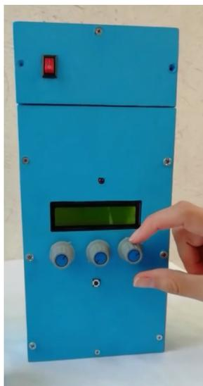
**Figura 6-75.:** Prototipo de laboratorio de biosensor final, cara frontal etapa de instrumentación en Protoboard de la etapa de instrumentación implementado en lactosuero residual. Fuente: Autor.
