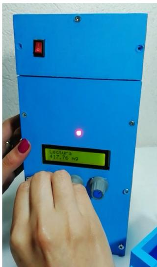
**Figura 6-78.:** Visualización tercera opción del menú mediante la pantalla LCD ubicada en la etapa instrumental del prototipo de laboratorio. Fuente: Autor.
