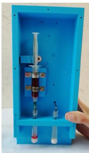
**Figura 6-81.:** Sistema de dosificación automático, etapa de reconocimiento, prototipo de laboratorio de biosensor, visualización interna. Fuente: Autor.
