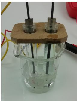
**Figura 5-11.:** Montaje inicial electrodo combinado: electrodo indicador-cátodo (grafito) y electrodo de referencia-ánodo (grafito y agente oxidante). Fuente: Autor.
