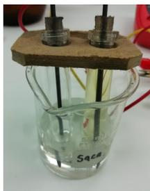
**Figura 5-2.:** Montaje inicial del electrodo combinado para la evaluación del Sulfato de Cobre (II) como agente oxidante. Fuente: Autor.
