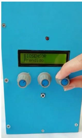
**Figura 6-76.:** Visualización primera opción del menú mediante la pantalla LCD ubicada en la etapa instrumental del prototipo de laboratorio. Fuente: Autor.
