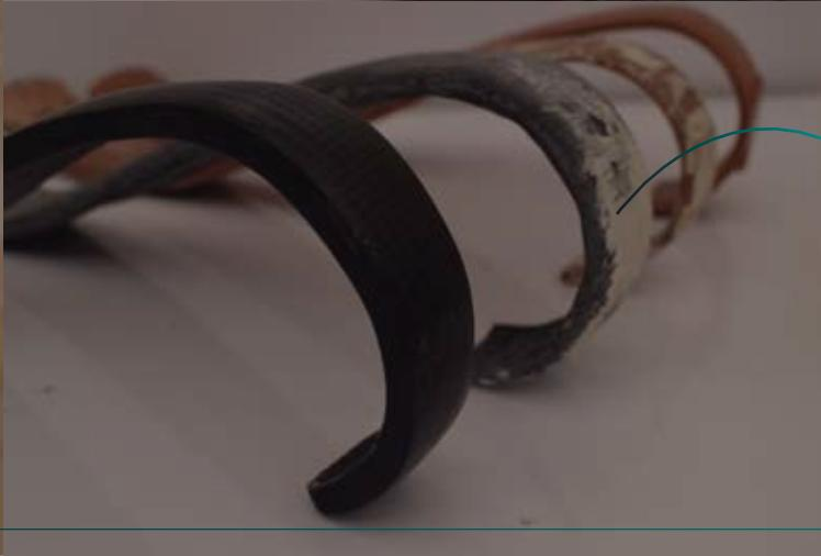
Al aplicar demasiada temperatura para acelerar el proceso de producción, el contra-molde empieza a sufrir deformaciones por lo tanto en el proceso no se debe elevar la temperatura a más de 60°.
