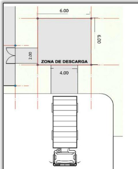
**Figura 36.** Plano de la zona de descarga escala 1:100
