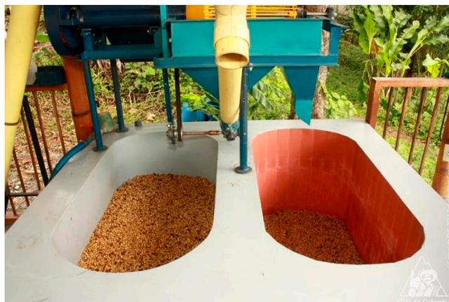
Figura 5: Fermentación del café por medio de tanque tina
