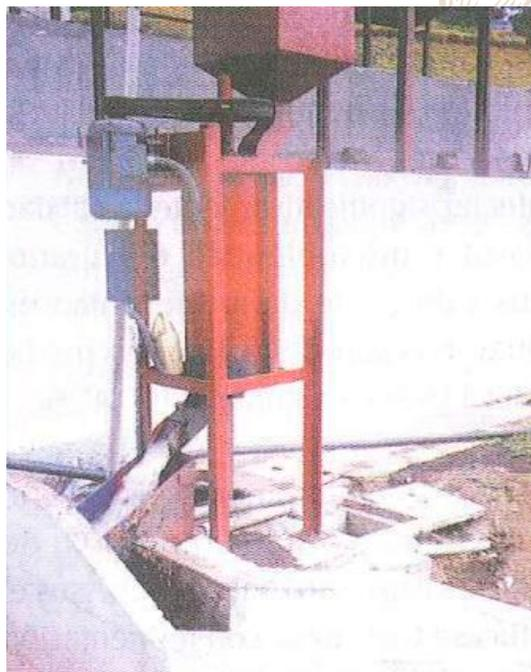
*Figura 15:* Desmucilagadora de flujo continuo tipo "Elmu"
