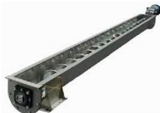
*Figura 11:* Tornillo sin fin de transporte
