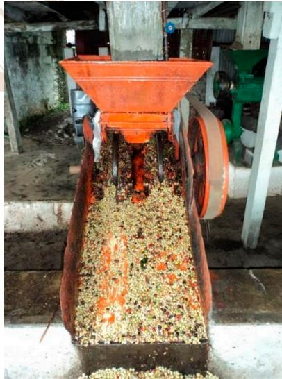
Figura 4: Sistema de despulpa de café
