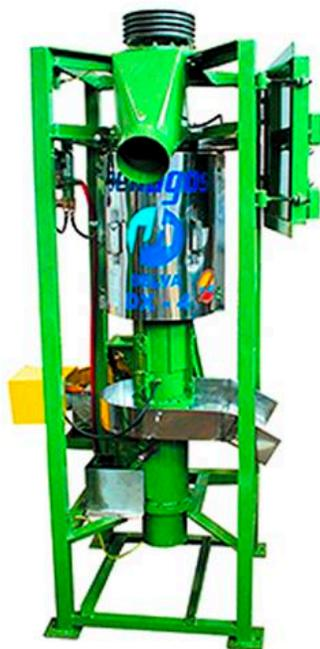
Figura 17: Desmucilaginador vertical ascendente delva dx – 4
