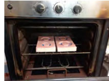
5. fundición del material HDPE-PEAD particulado.
