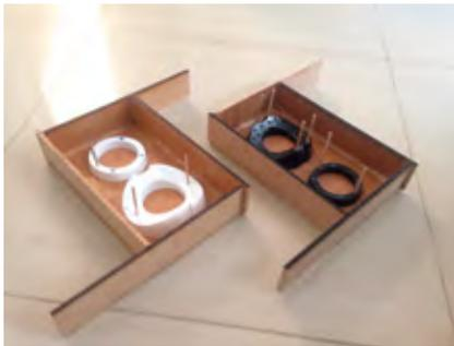
2. Colocación de los modelos impresos en 3D con sus respectivos canales de desmoldeo
