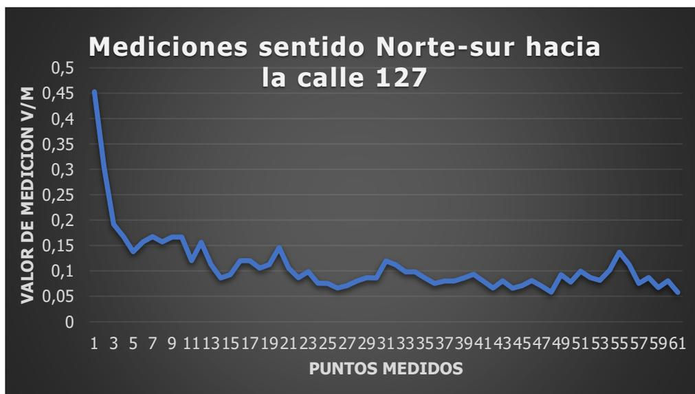
Figura 34 Gráfica de valores obtenidos antena omnidireccional sentido norte- sur
