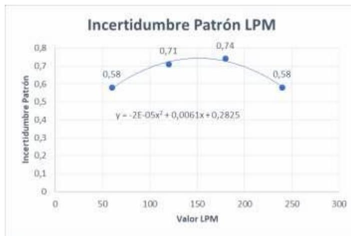
Ilustración 29. Interpolación incertidumbre patrón MPS450
