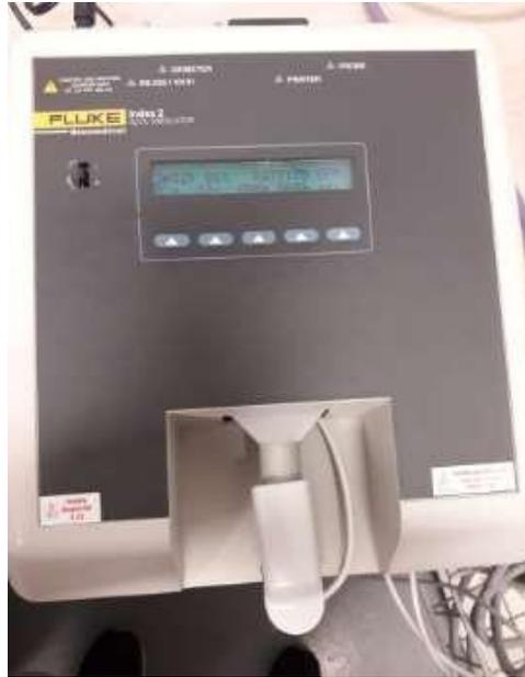
*Ilustración 24. Simulador saturación de oxígeno*
