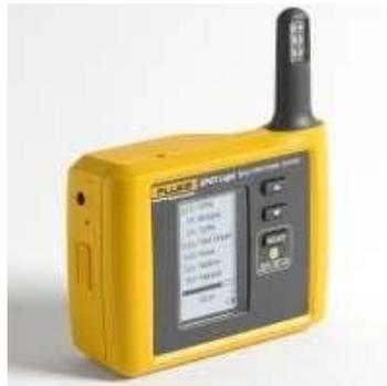
Ilustración 10. Simulador de saturación de oxígeno.
