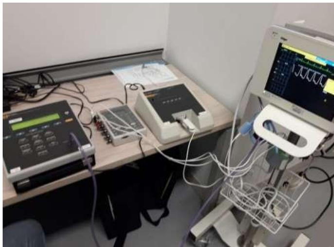
*Ilustración 27. Conexión accesorios variables fisiológicas.*
