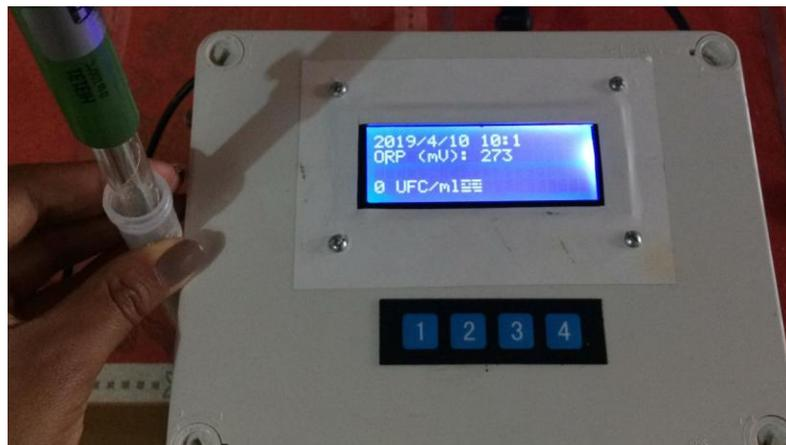
Figura 29 Medición de ORP con el equipo.
