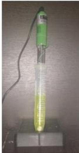
Figura 7 ejemplo usando un volumen de 1.5 mL de muestra para la medición.
