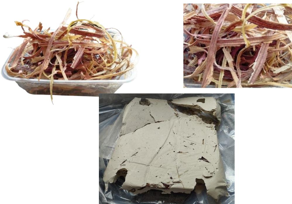
Aunque la placa se fracturó, las fibras impidieron que la estructura se separara por completo.
