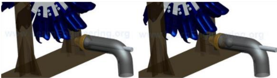
Figura 14. Control del caudal del agua en la turbina Pelton mediante el control de la posición de la punta de la lanza
