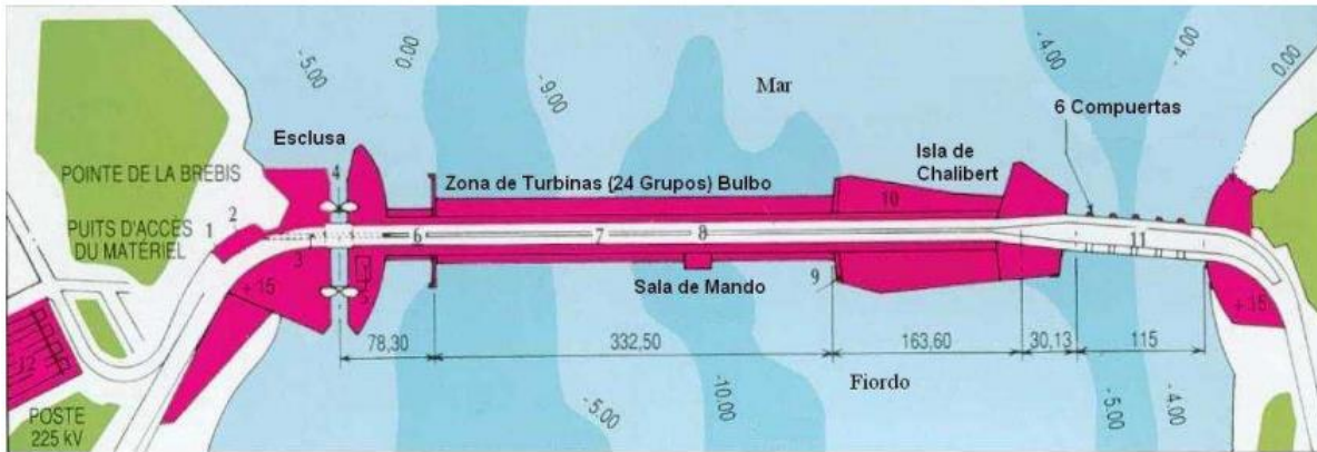
Figura 25. Esquema central mareomotriz La Rance.
