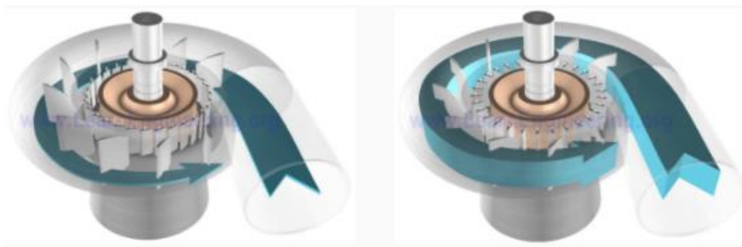
Figura 19. Flujo de entrada según ángulo de paletas Fuente: (Mathew, 2018)
