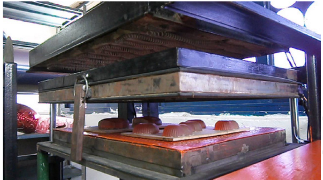
en ABS por termoformado se realiza la carcasa.
