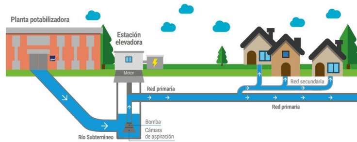
Figura 14. Sistema de distribución de agua potable
