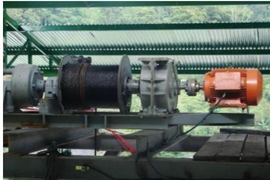
*Figura 5.* Sistema de malacate para extraer estériles hasta superficie
