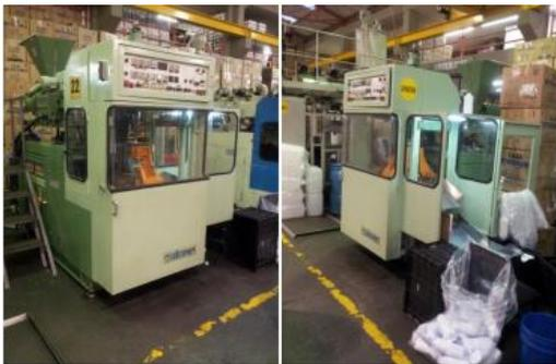
*Figura 27. Máquina de soplado
