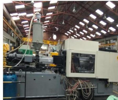
*Figura 28. Máquina de inyección
