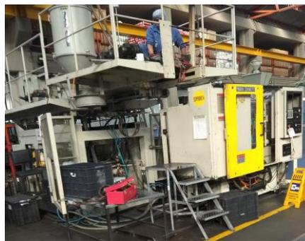
*Figura 26. Máquina de Inyección
